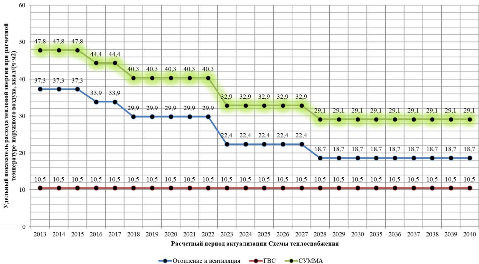
Рисунок 4.1-1 - Изменение нормируемого удельного расхода тепловой энергии на отопление, вентиляцию и ГВС на примере жилого 12-этажного многоквартирного дома
